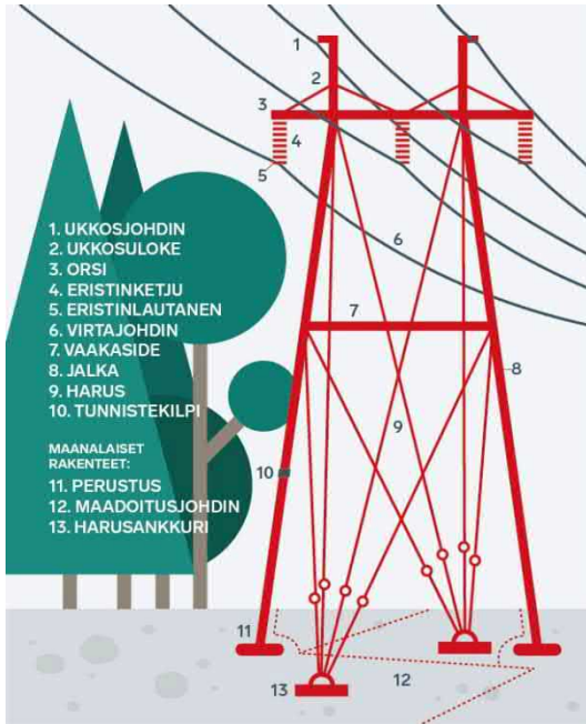
Kuva 2-6. Voimajohdon osat (Fingrid 2020).
